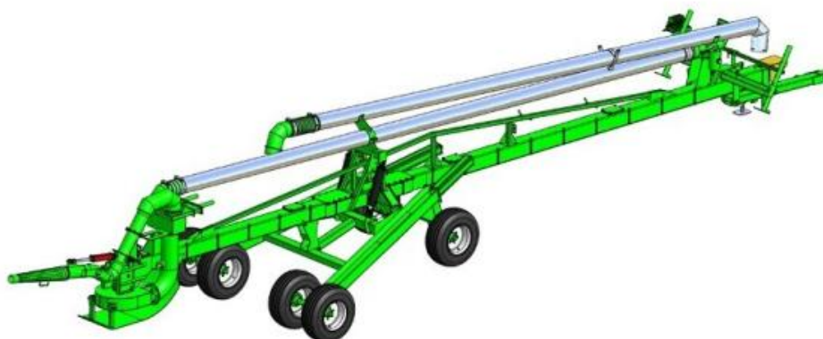
Лагунная помпа PL490K в положении для перемешивания донного осадка
